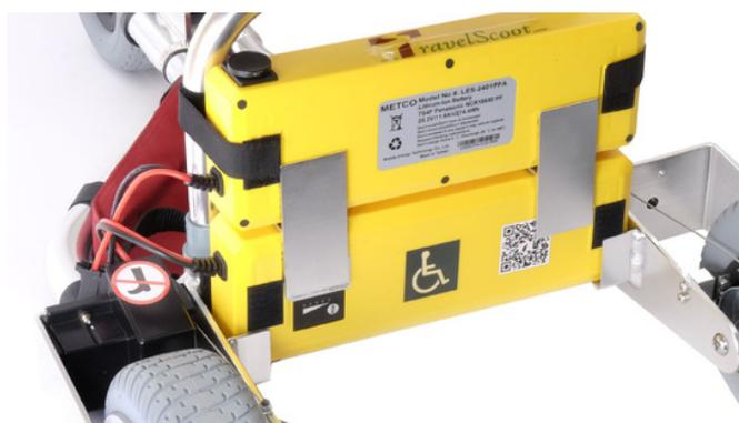
3. Posizionare la seconda batteria nei profili H e allinearla alla batteria inferiore. Il cavo della batteria deve stare in **basso a sinistra**, cosicché le due batterie non devono essere risistemate al momento di cambiarle.
