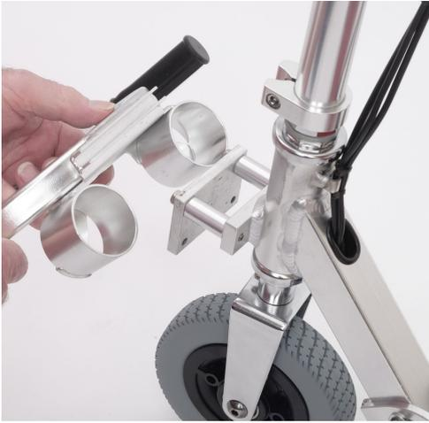
1.) Fußstützen durch Lösen der zwei Schrauben wegnehmen und durch die Verlängerungsplatte ersetzen
